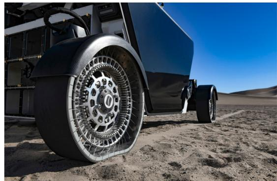
Dès 2026, lors de la mise en service du rover FLEX au pôle Sud lunaire – où règnent des températures extrêmes ( $-90^{\circ}\text{C}$  à  $-230^{\circ}\text{C}$ ) – les quatre roues supportant les 2 tonnes de masse du véhicule (charge utile incluse) absorberont les irrégularités du sol en se déformant et ce, alors que FLEX se déplacera à 20 km/h. La roue devra,
